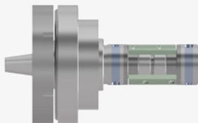
Die Spindel wird durch ein konisches Spannsystem (z.B. HSK) fixiert. Die Ansteuerung erfolgt hierbei über einen berührungslosen ringförmigen Kollektor.
